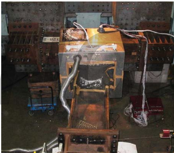
ESW脆性破壊が生じない場合は、大きく変形
