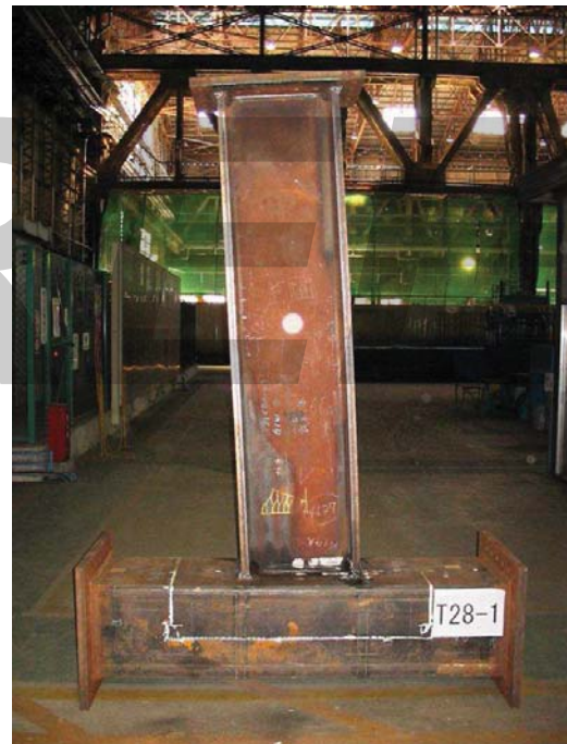
ESW脆性破壊が生じない場合は、大きく変形
