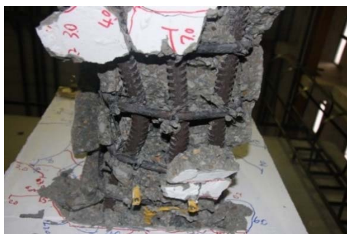
圖 10 HR-Y0-S 試體，於 DR=6% 接近實驗終止時，受壓 #8 筋產生明顯挫屈後(左圖)，於下一拉力循環造成鋼筋拉斷情形(右圖)
