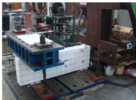
圖7 握裹試驗之實際試驗裝置圖
