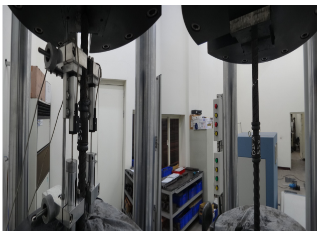
照片 9 磨擦焊接高塑性(SA 級)測試
