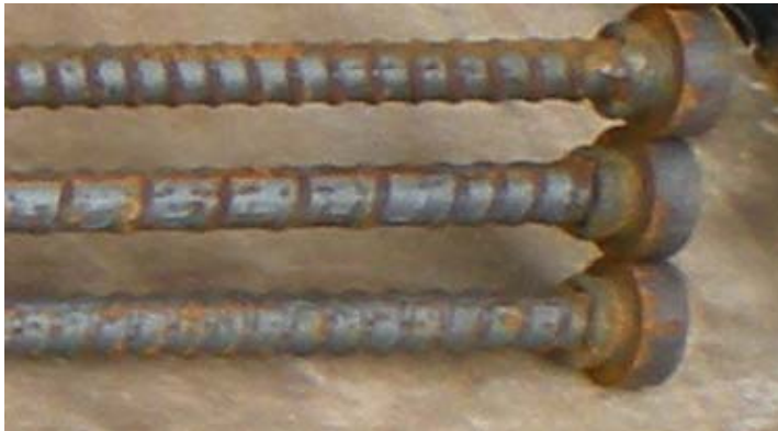
銲接式錨定頭鋼筋
