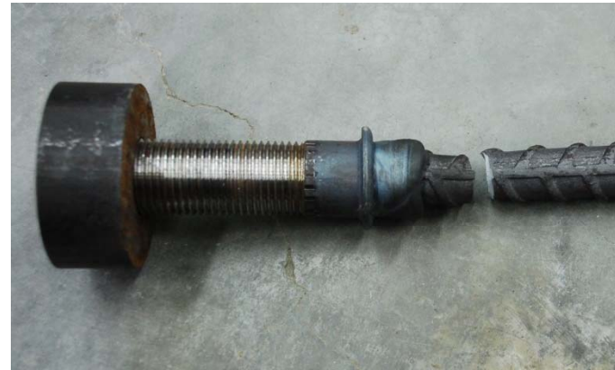
銲接螺紋式錨定頭鋼筋
