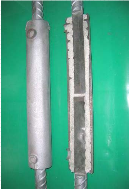
灌漿套筒續接器 偏移 \pm 20 伸入 +0-10 ； \pm 20
