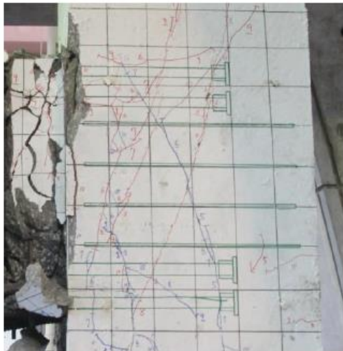
LAMV 破壞時接頭處裂縫分布
