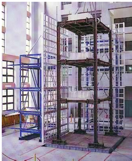
圖二 三軸向地震模擬振動
