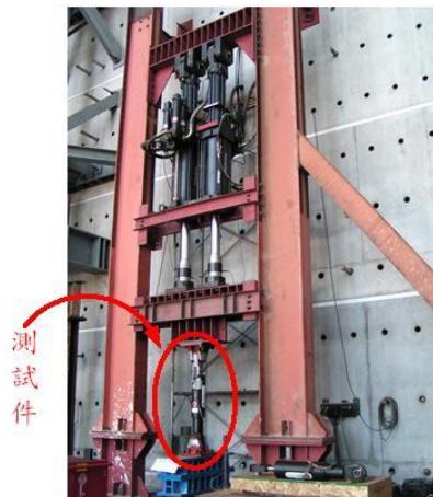
圖七 阻尼器(測試件)反覆載重測試
