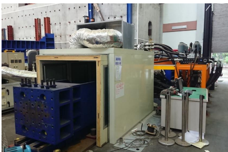
圖十一 圖左為致動器已位於溫控箱內，圖右為系統配置示意圖
