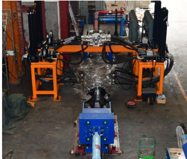
圖十 高性能消能元件測試系統(致動器尚未裝於溫控箱內)
