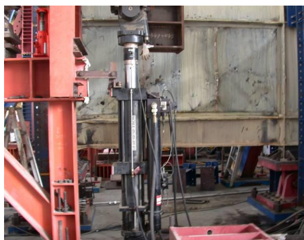
圖九 動態油壓致動器
