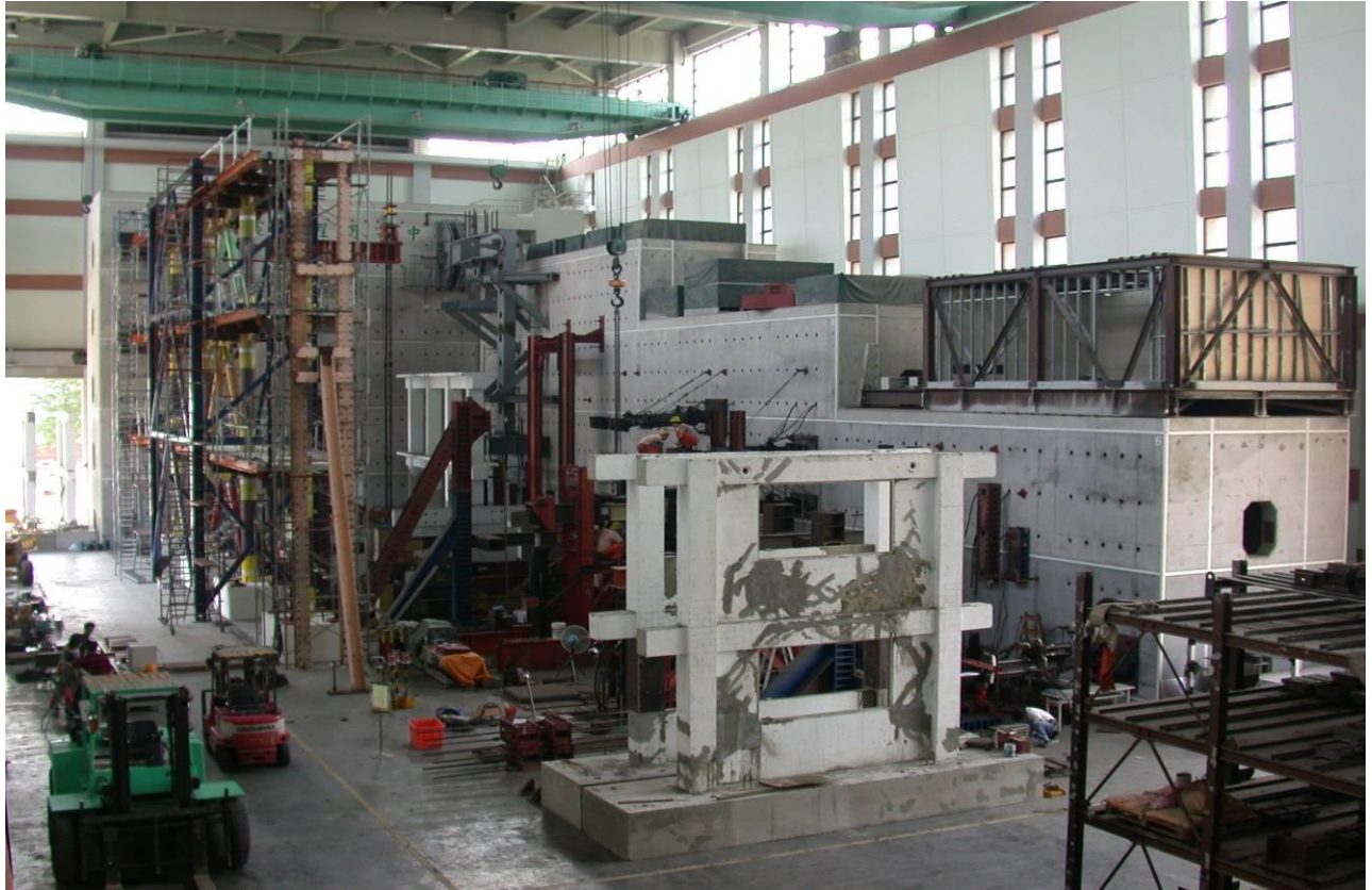
圖四 反力牆與強力地板實驗室
