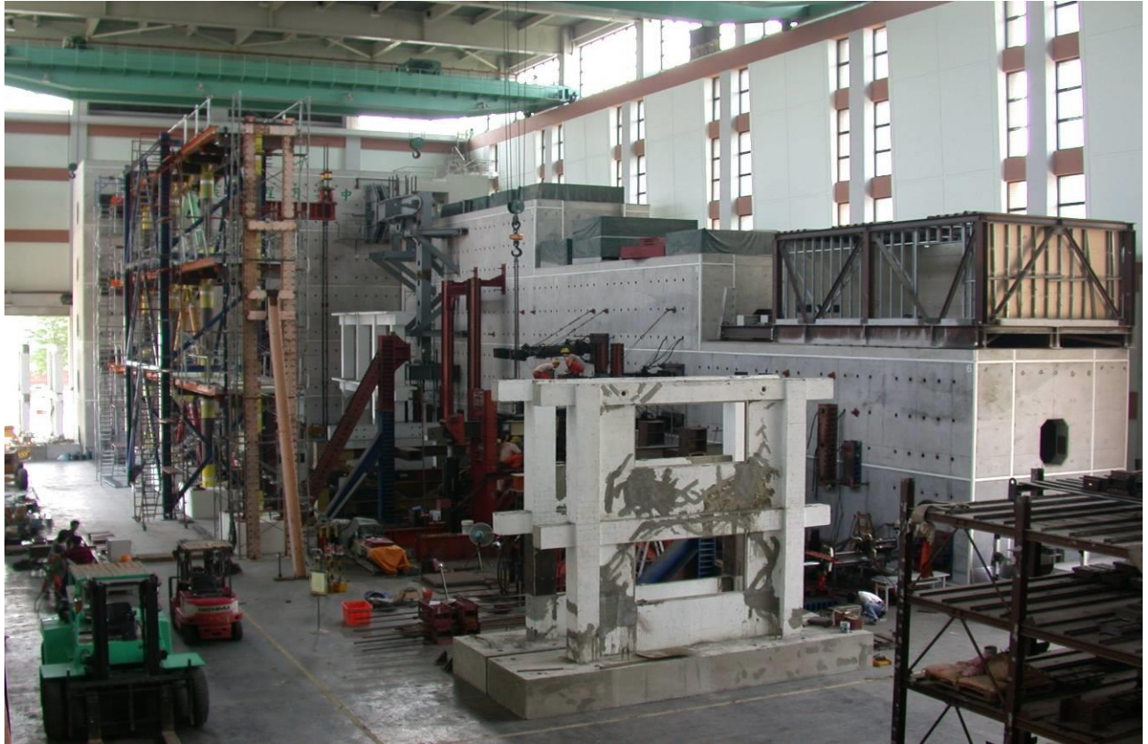
圖四 反力牆與強力地板實驗室
