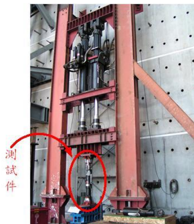
圖七 阻尼器(測試件)反覆載重測試
