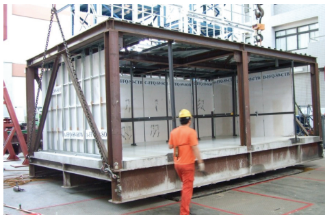
圖六 模型屋固定於振動台上
