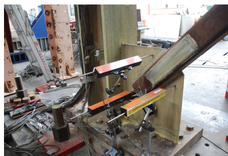
圖七 底部接合板面外變形量測
