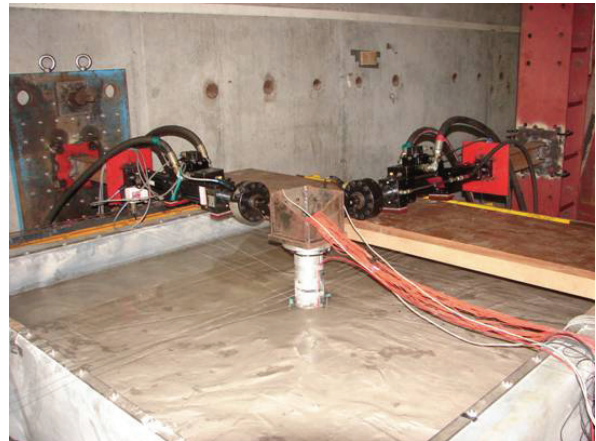
圖二 基樁在飽和砂土中之側向載重試驗
