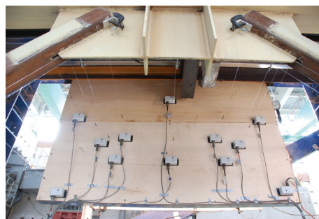
圖六 頂層梁中間接合板面外變形量測
