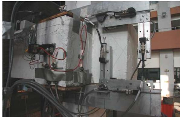
圖 4 梁柱接頭儀器佈置
