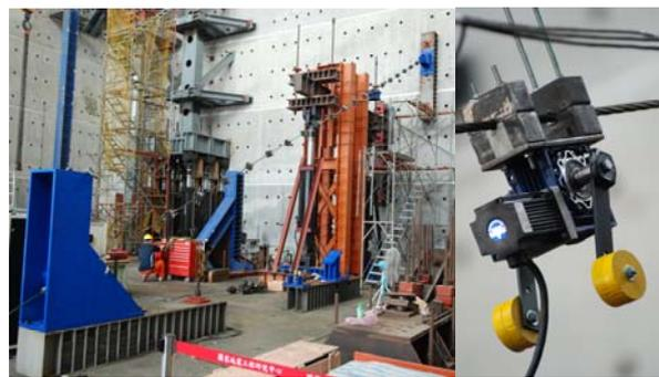
圖二：斜張鋼纜實際照片 (左)，鋼纜的振動器 (右)
