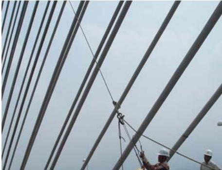
圖三 施加拉力後，釋放扣環，鋼纜振動
