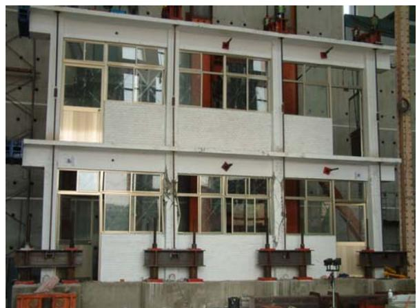
圖五 校舍試體最後破壞照片(位移歸零)
