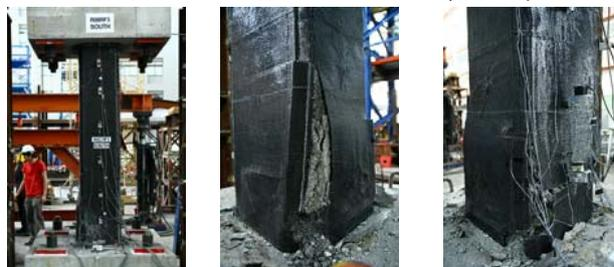
照片四 試體 R08RF3 破壞模式
