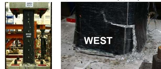
照片五 試體 R08RF4 破壞模式
