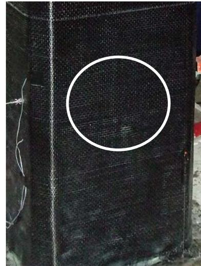
圖三 採碳纖維錨栓補強試體完成圖
