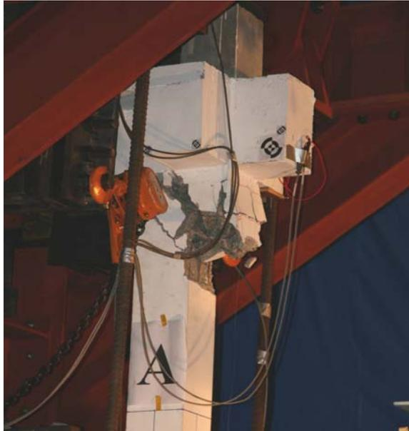
圖 5 A柱二樓破壞
