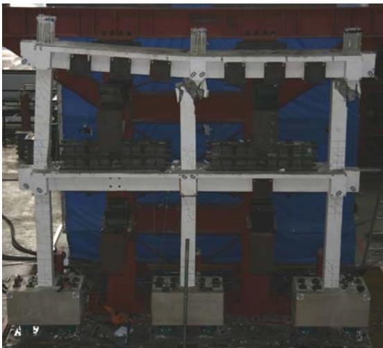
圖 6 試體於實驗中破壞的情形
