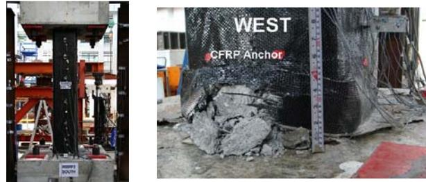
照片三 試體 R08RF2 破壞模式
