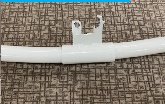
2F 連桿破壞/變形
