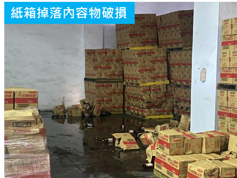
箱裝貨物堆垛倒塌
