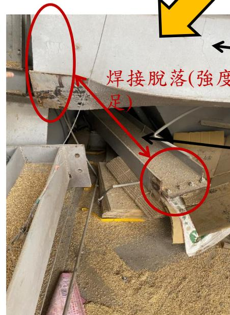
依現勘推估：或許因樑間焊接強度不足造成脫落，導致螺栓剪斷，引致骨牌效應
