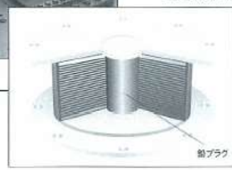
■鉛プラグ入り 積層ゴム 断面図
