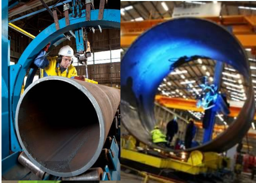
焊工無法進入直徑小於1500mm之管內銲接
