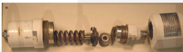
圖三 Emeryville 公車加氫站失效洩壓閥元件 (Harris et al., 2012)
