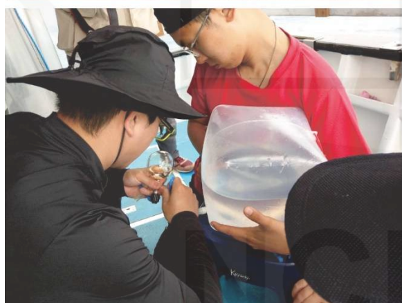
圖二 海底氣體採樣與船上樣品轉移作業示意圖。(上)潛水人員於海底噴氣口以氣袋進行排水集氣採樣；(下)船上將氣體樣品轉移至吉氏採樣瓶進行保存。
