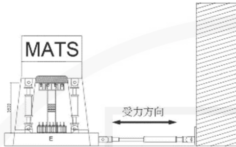
圖四 鋼骨連桿梁試驗配置圖
