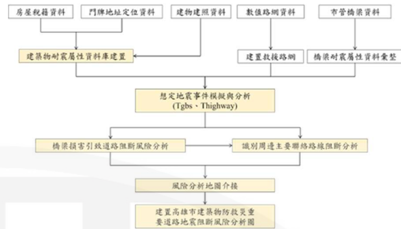
圖五 地震情境模擬與道路阻斷分析流程
