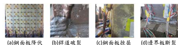
圖七 撓曲破壞之破壞演進示意圖 (SCB5)
