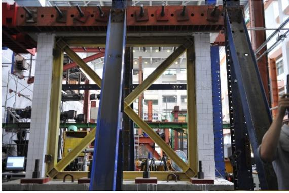
Fig. 1: Specimen CPFX.
