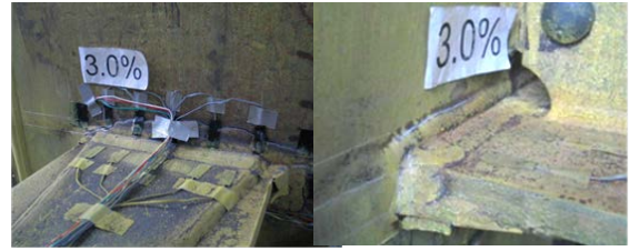
(a)試體 E1BSPN 之破壞情況
