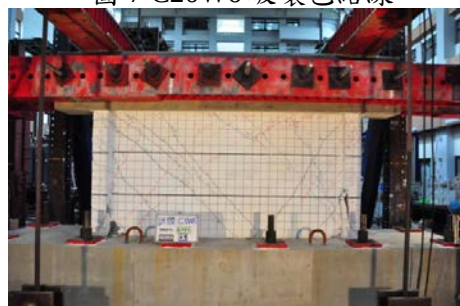
圖 8 C20W6 試驗結束點裂縫發展
