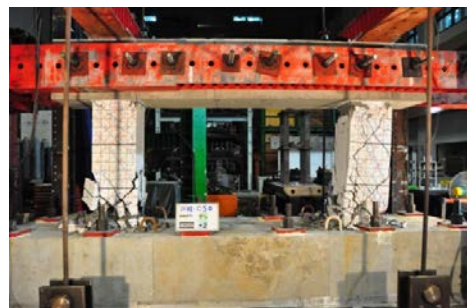
圖 2 C50 試驗結束點裂縫發展
