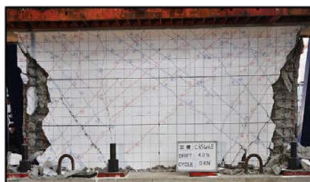
圖 8 C35W6E 試驗結束點裂縫發展
