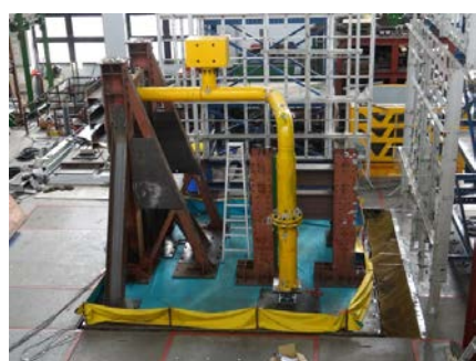
圖三 振動台管線試體配置圖
