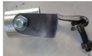
圖 5 受剪試驗之破壞模式
