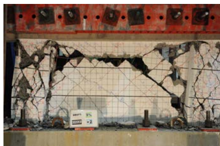
圖 4 C50W6 試驗結束點裂縫發展
