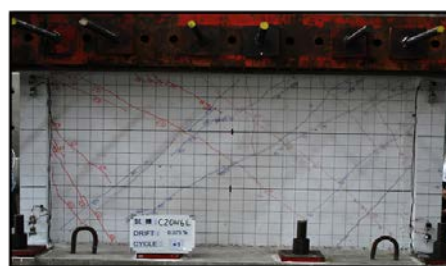
圖 3 C20W6E 極限強度點裂縫發展
