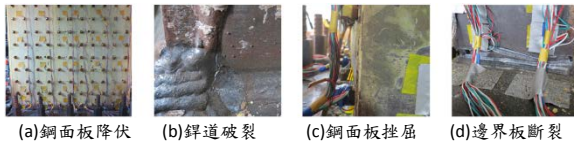
圖七 撓曲破壞之破壞演進示意圖 (SCB-3)
