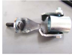
圖 3 受拉試驗之破壞模式
