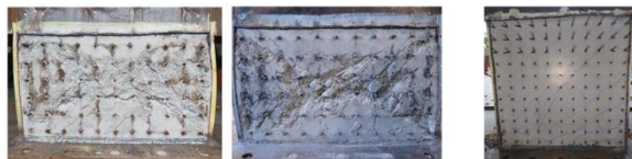
圖八 試驗終止時之核心混凝土破壞狀態
