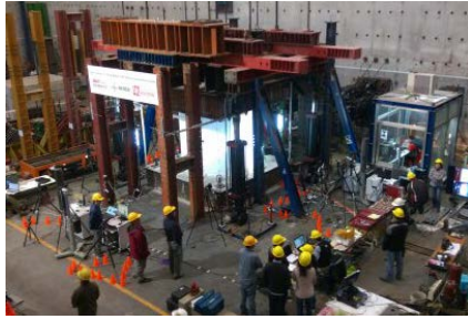
圖一 圍阻體縮尺試體反覆載重試驗實況
