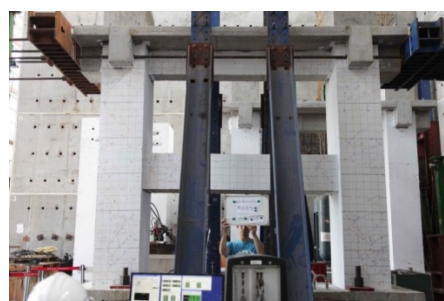
圖 3.2 試體 CJB 擬靜態側推試驗
