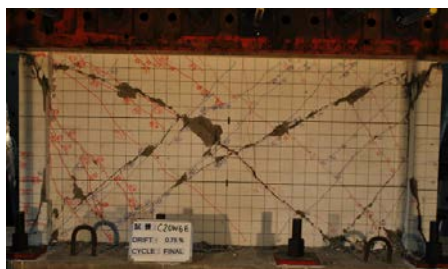
圖 4 C20W6E 試驗結束點裂縫發展
