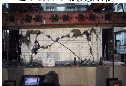
圖 6 C35W6 試驗結束點裂縫發展
