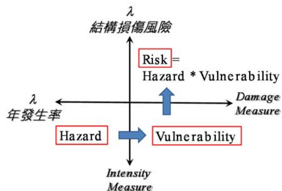
圖 3 損傷風險之計算格式
