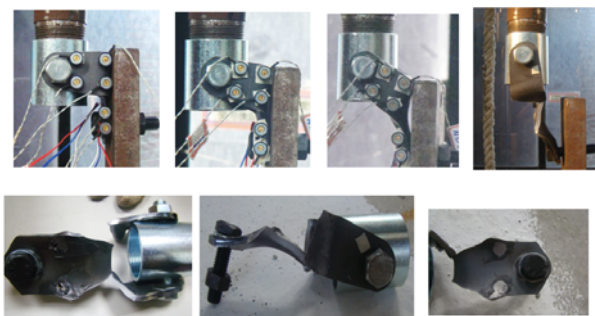
圖 14 MT2 連接裝置破壞圖
