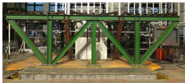
圖 1 振動台實驗現地構架
