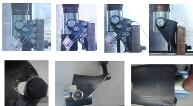
圖 15 MT3 連接裝置破壞圖
