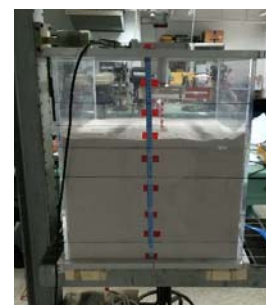
圖三 靜力側推實驗配置圖
