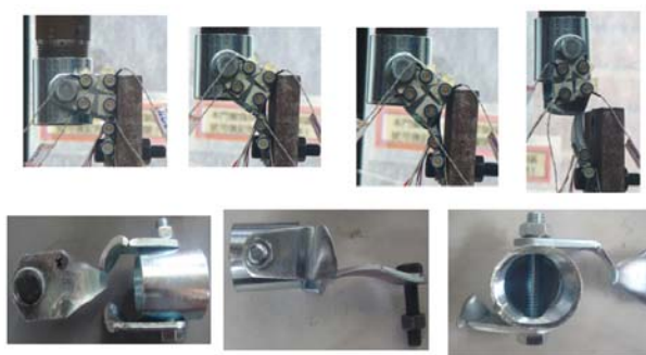
圖 13 PT 連接裝置破壞圖
