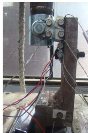
圖 12 剪力試驗配置圖
