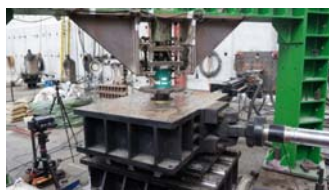
圖一 試驗裝置之實體配置
