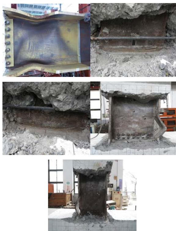
圖 7 反覆載重試驗後五組試體破壞情形
