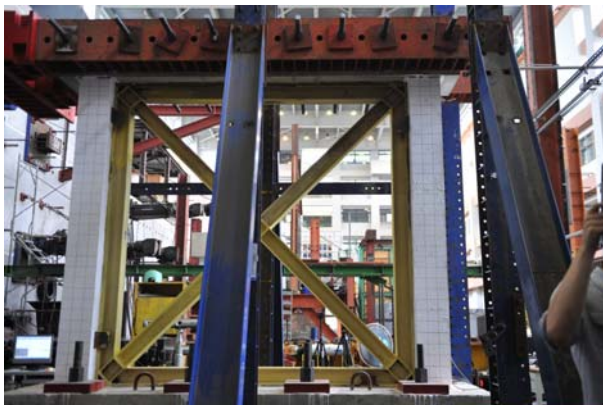
圖 1 補強試體 CPFX 試體圖
