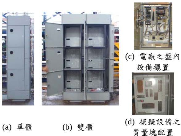
圖一 電氣盤體試體(間層高度 600mm)配置
