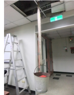
圖12 抗拉強度測試
