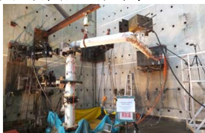
圖二 管線系統試體
