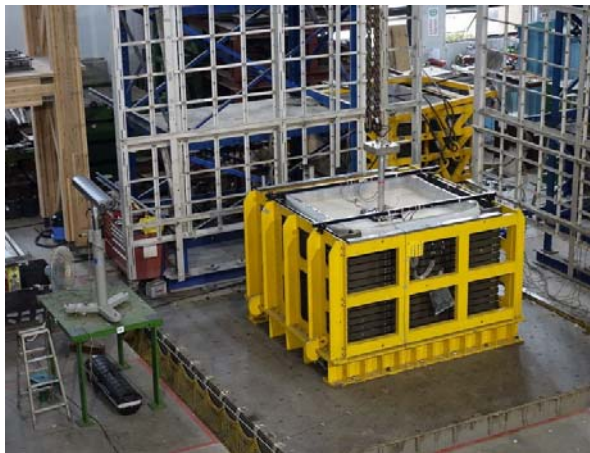
圖二 振動台動態試驗
