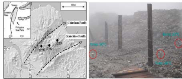
圖二 土氣觀測點的位置與探測器於現地安裝的狀況（紅圈為設置點）。
