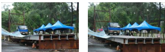
(b)靜態載重實驗 (c)動態載重實驗
