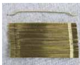
圖 3 高強度彎鉤鋼纖維
