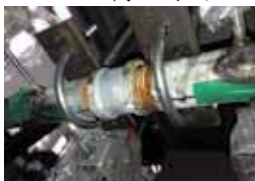
圖 13 螺紋接頭破壞圖
