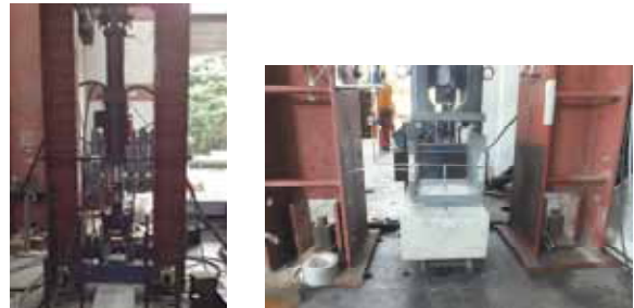
圖二 拉力試驗配置
