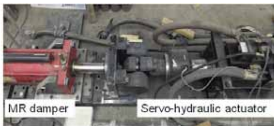
圖九 大型磁流變阻尼器試驗架設
