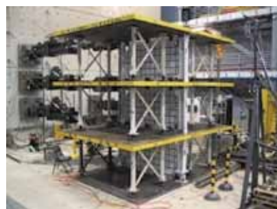
圖 5 在 UB 實驗室進行之 1/3 縮尺三層樓構架試體靜態試驗配置
