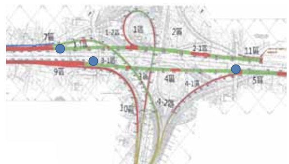
圖八 五楊高架橋三跨監測地點(藍圈)
