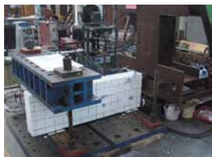
圖三 握裹試驗之實際試驗裝置圖
