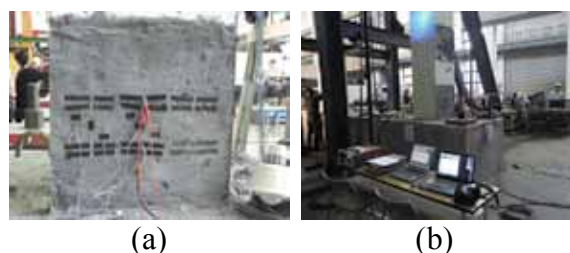
圖 3 橋柱試體(a)電極配置與(b)試驗設置
