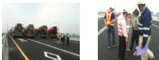
圖二 102 年 3 月，載重實驗與水準測量
