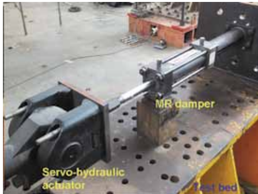
圖五 智慧型結構即時複合試驗試驗架設
