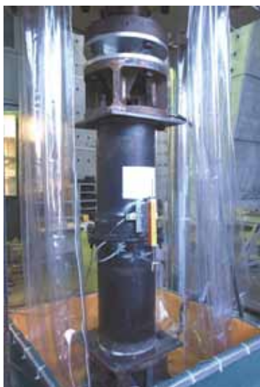
圖二 自來水管材軸拉、軸壓試驗
