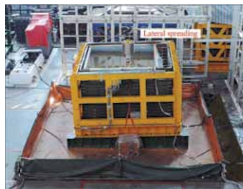
圖三 土壤液化引致 X 方向地盤側潰位移
