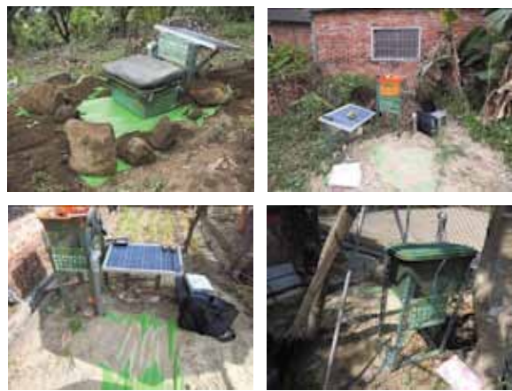
圖二 數個嘉南地區微地震監測站之照片
