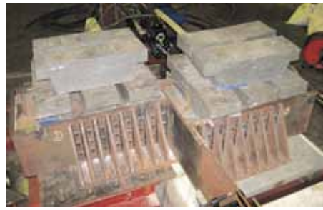
圖四 剪力箱上擺置鉛塊
