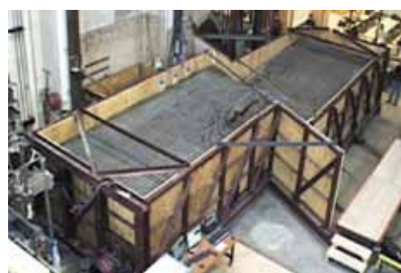
圖一 大尺度地下管線剪力箱實驗
