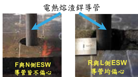
圖五 電熱熔渣鋁導管對鋁接熔池不偏心與偏心之鋁接程序
