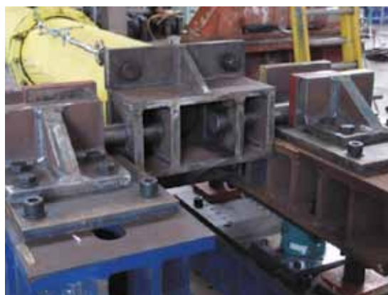
圖四 撓曲試驗試體端部安裝於鉸支承
