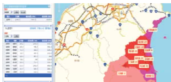
圖五 自來水管線早期損失評估範例
