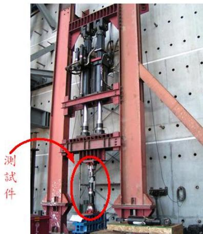
圖七 阻尼器(測試件)反覆載重測試
