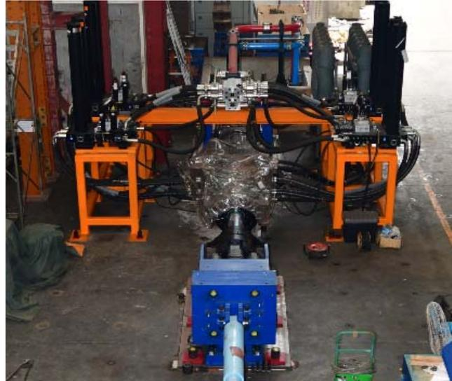
圖十 減震消能元件測試系統(致動器尚未裝於溫控箱內)
