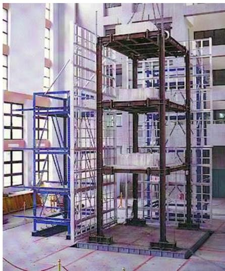
圖二 三軸向地震模擬振動
