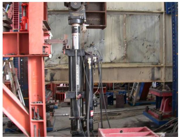
圖九 動態油壓致動器
